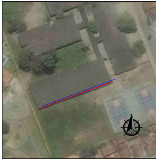
Figura 2. Exemplo de avaliação da precisão de distâncias a partir de linhas no bairro Santa Amélia, Maceió/AL.
